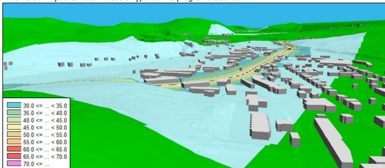
Obr. 5 – 3D model šíření hluku z železniční dopravy (rok 2033)
